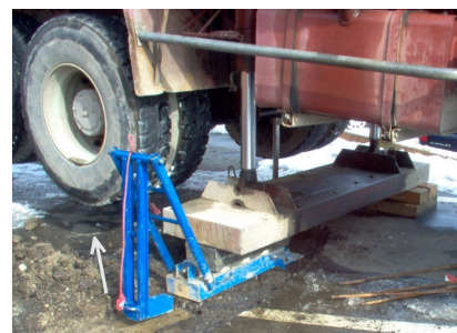
Figura 3.4-59 - Sorgente di energizzazione in superficie
