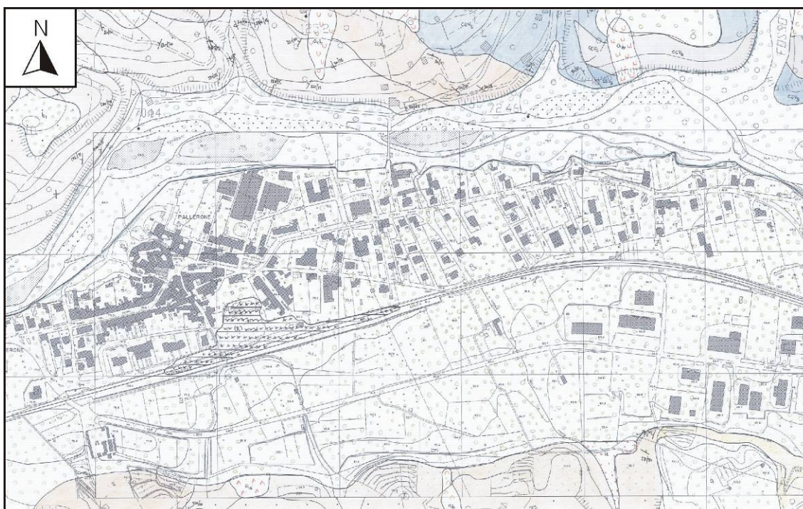
Figura 3.4-6 – Esempio di carta geomorfologica realizzata nell'ambito del Progetto VEL (Regione Toscana) da rilievo in scala 1:2.000 (ai fini della rappresentazione nel presente documento la scala è stata ridotta).
